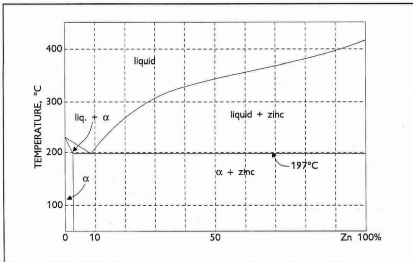
Fig. 1 THE TIN-ZINC PHASE DIAGRAM
